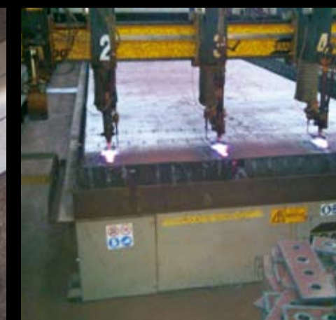
Ossitaglio e plasma Esab ad alta definizione con marcatura pneumatica multicannello (piano taglio 12000x2500x3 cannelli, spessore max 300 mm)
