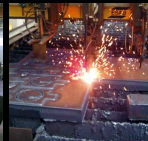
Ossitaglio e plasma Esab ad alta definizione con marcatura pneumatica multicannello (piano taglio 12000x2500x3 cannelli, spessore max 300 mm)
