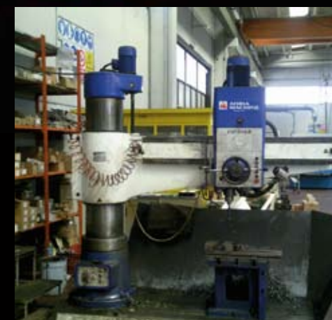
Foratura dal pieno fino a diametro di 50 mm
