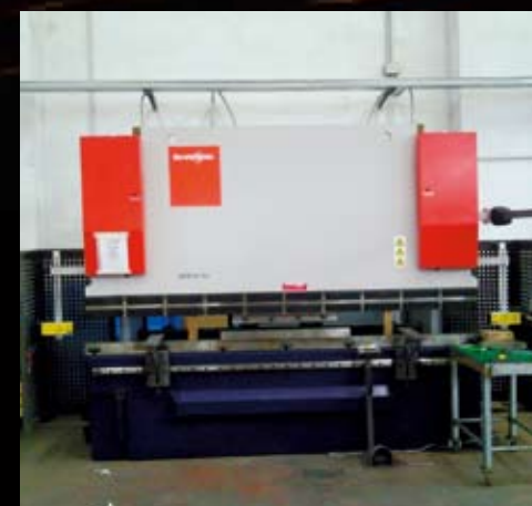
Piegatrice da 3 mt. di 160 tonnellate controllata a quattro assi con tavola dinamica di compensazione, spessore massimo di piega 10 mm per una profondità di 800 mm
