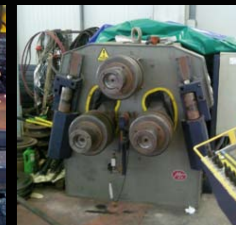
Curvaprofilati a Controllo Numerico per tubi fino ad un diametro max di 139 mm
